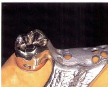
3-3 そのままの位置で直径 1.2 mm のミリングドリルに交換し、内冠を 0.6 mm の深度でミリングする
