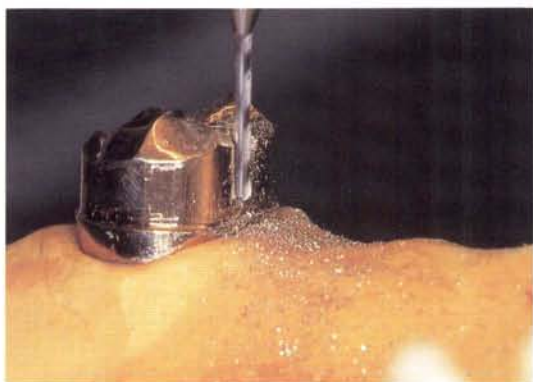
3-3 そのままの位置で直径 1.2 mm のミリングドリルに交換し、内冠を 0.6 mm の深度でミリングする
